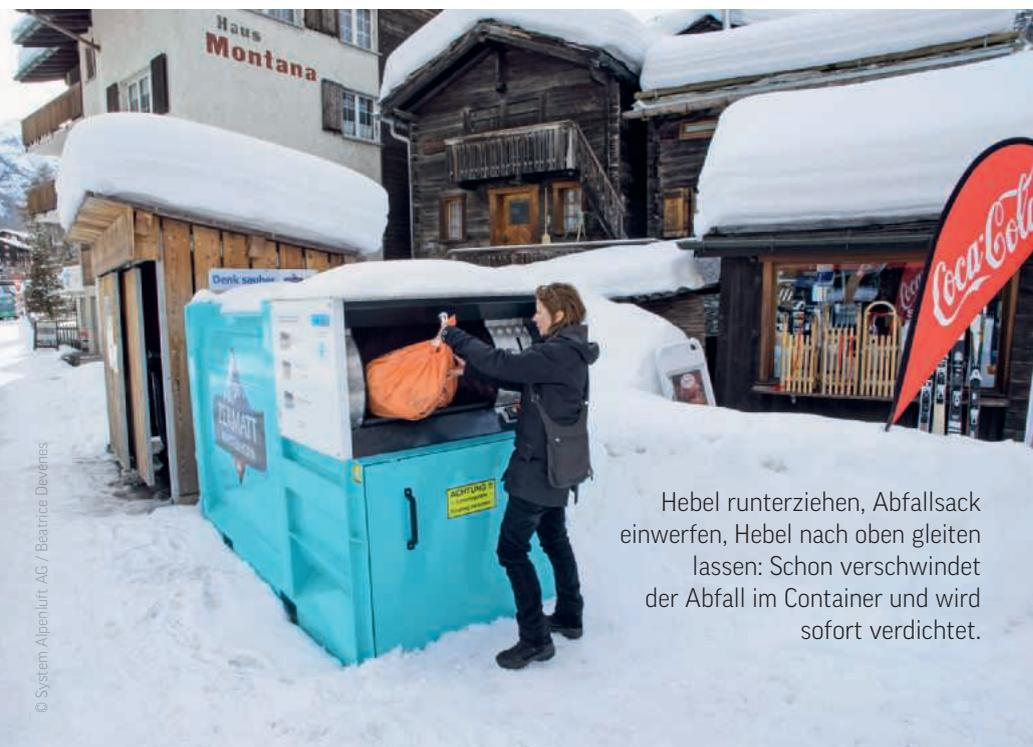
Hebel runterziehen, Abfallsack einwerfen, Hebel nach oben gleiten lassen: Schon verschwindet der Abfall im Container und wird sofort verdichtet.
